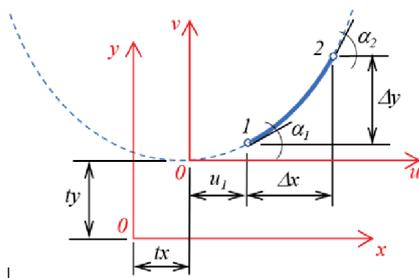
Figura 2 – Segmento parabólico e sistemas de coordenadas global e local
