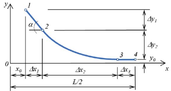
Figura 3 – Exemplo de perfil longitudinal de cabo de protensão de vig isostática simétrica
