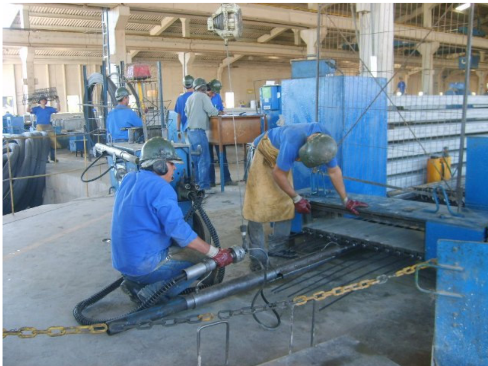
Figura 26 – Alongamento de cordoalhas
