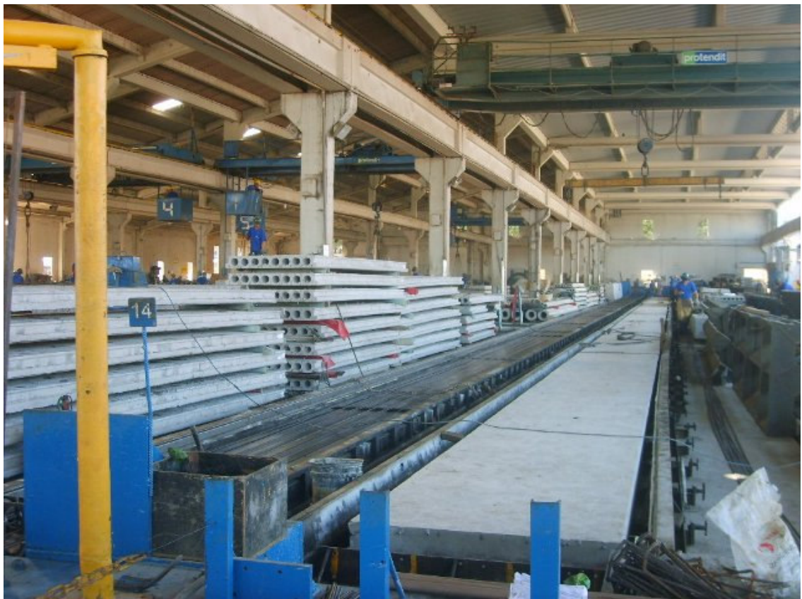
Figura 11 – Pistas de protensão em indústria de pré-moldados
