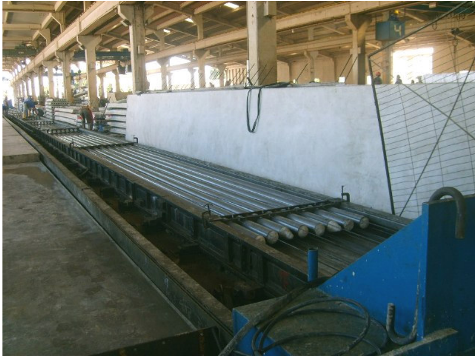
Figura 29 – Tubos de aço para formação de alvéolos
