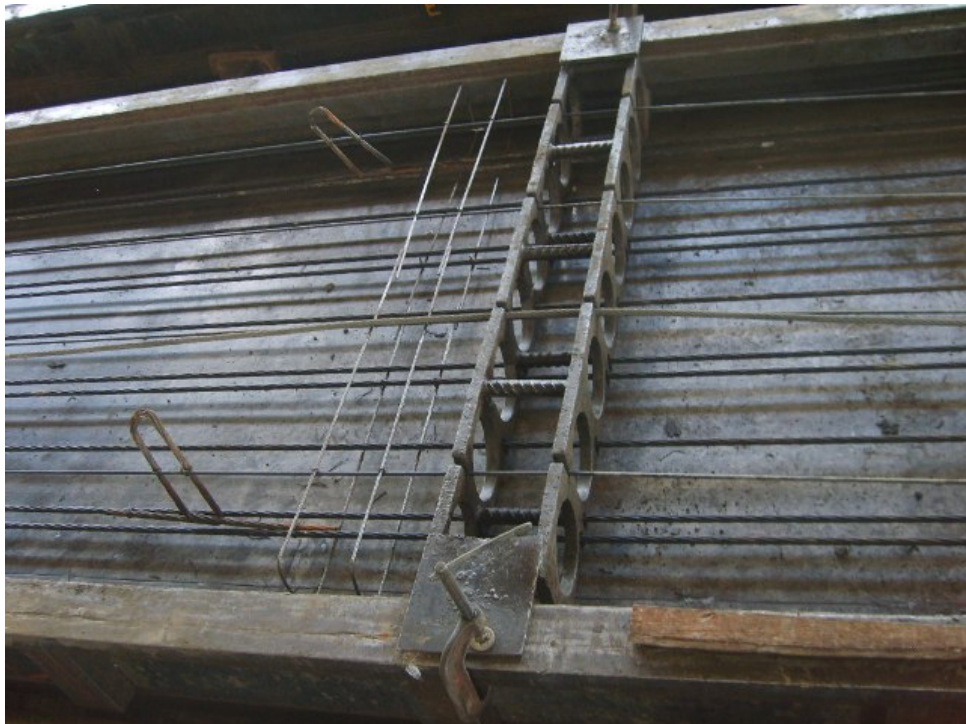
Figura 28 – Gancho de içamento e perfil limitador de laje alveolar
