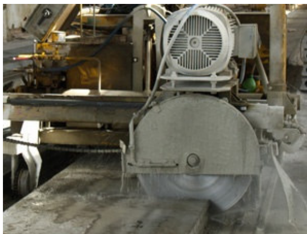
Figura 21 – Corte por disco diamantado de laje alveolar extrudada
