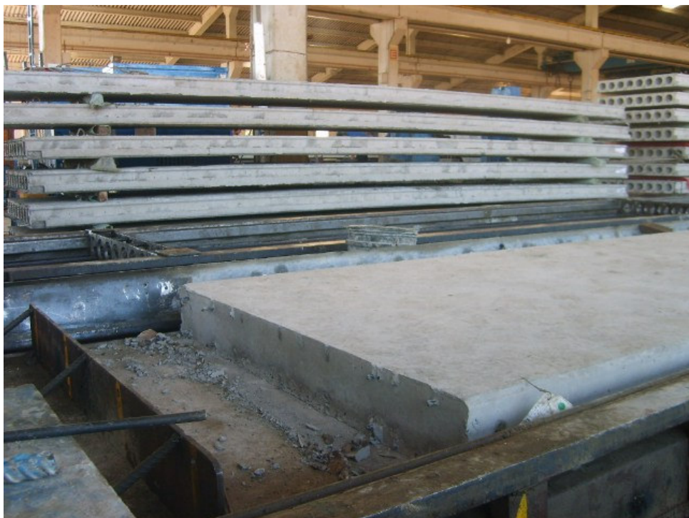
Figura 34 – Extremidade da laje pré-moldada antes do corte final das cordoalhas
