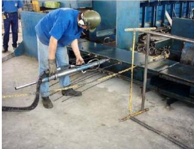
Figura 12 – Macaco de protensão de monocordalha
