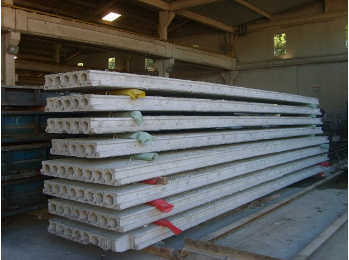
Figura 24 – Estocagem de lajes alveolares com calços de madeira
