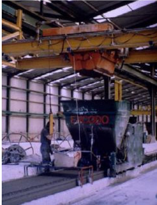
Figura 20 – Produção de lajes por extrusão
